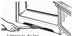
Limpieza de los serpentines del condensador
